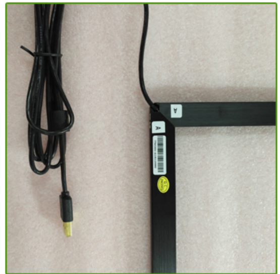
16、A-A安装完成，B-B,C-C，D-D按此方法依次安装。
